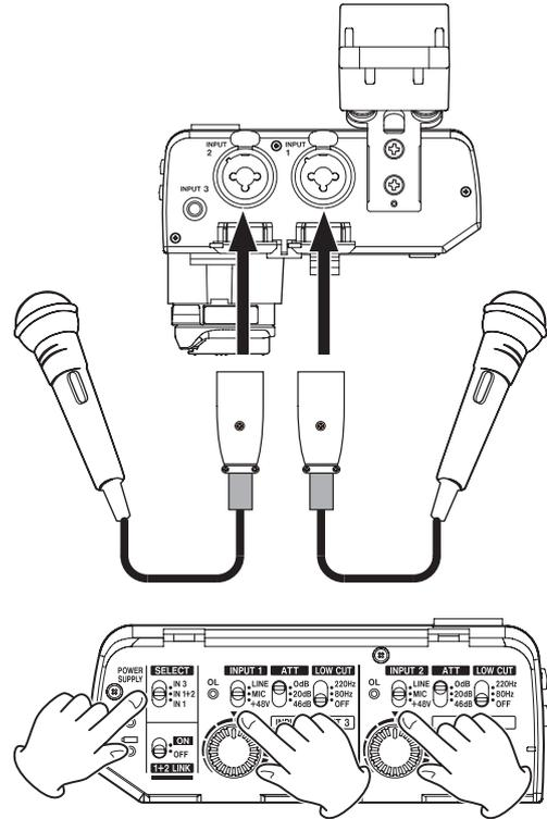
Stellen Sie den Schalter **SELECT** (2) auf **IN 1+2** und die Schalter **INPUT 1** (4) und **INPUT 2** (7) auf **MIC**.
