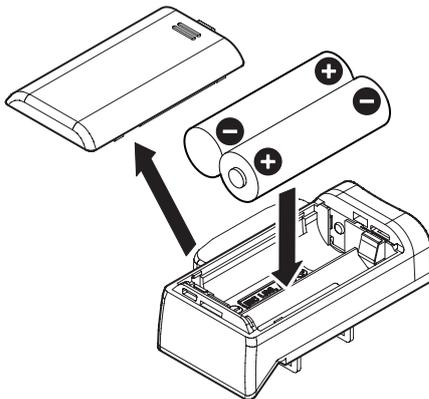
3 Setzen Sie die Batteriefachabdeckung wieder ein.
