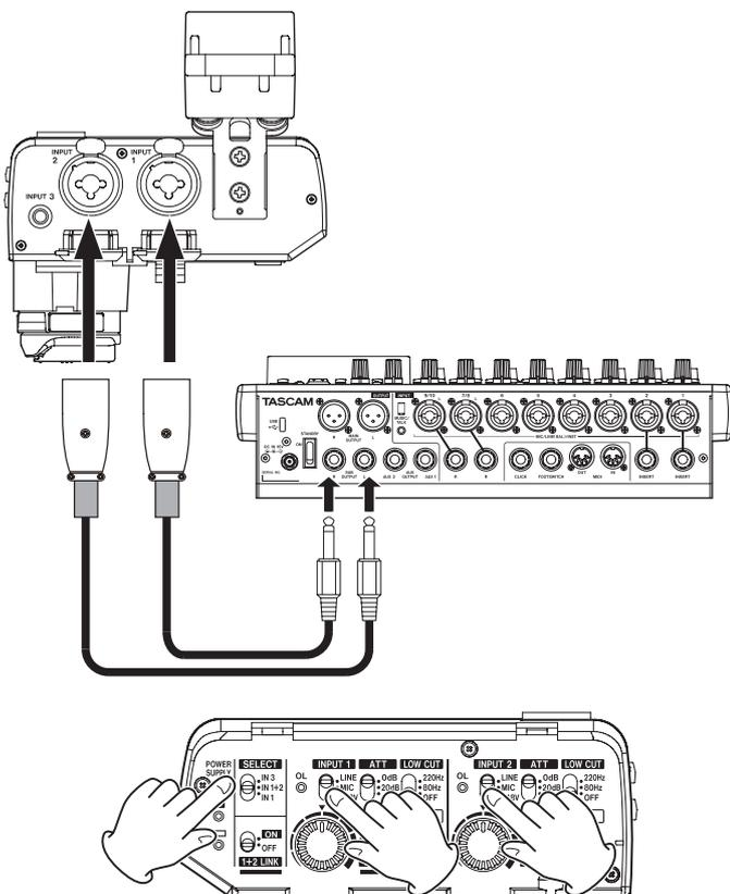
Wenn Sie ein Mischpult oder ein anderes Gerät mit Line-Pegel anschließen, verbinden Sie es über XLR- oder dreipolige Klinkenkabel mit dem CA-XLR2d. Stellen Sie dann die Schalter **INPUT 1** (4) und **INPUT 2** (7) auf **LINE**.
