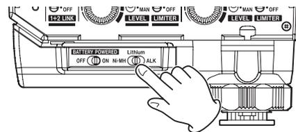
7 Stellen Sie den Schalter BATTERY POWERED (25) auf ON, um den Batteriebetrieb zu aktivieren.
