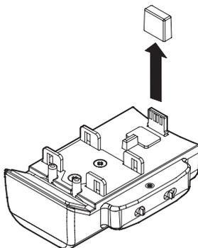
5 Entfernen Sie die Schutzabdeckung auf der Unterseite des CA-XLR2d und befestigen Sie den Batteriehalter.
