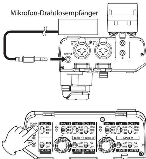
Wenn Sie beispielsweise ein Stereo-Ansteckmikrofon oder den Empfänger eines Drahtlos-Mikrofons anschließen, verbinden Sie es mit dem Anschluss **INPUT 3** (21), und stellen Sie den Schalter **SELECT** (2) auf **IN 3**.
