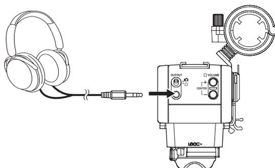
Um das analoge Audiosignal abzuhören, stellen Sie den Schalter **OUTPUT** (14) auf Kopfhörer (Ω), und verbinden Sie Ihre Kopfhörer oder Ohrhörer mit dem Anschluss **OUTPUT** (15). Nutzen Sie dann die Tasten **VOLUME +/-** (16), um die Kopfhörerlautstärke anzupassen.
