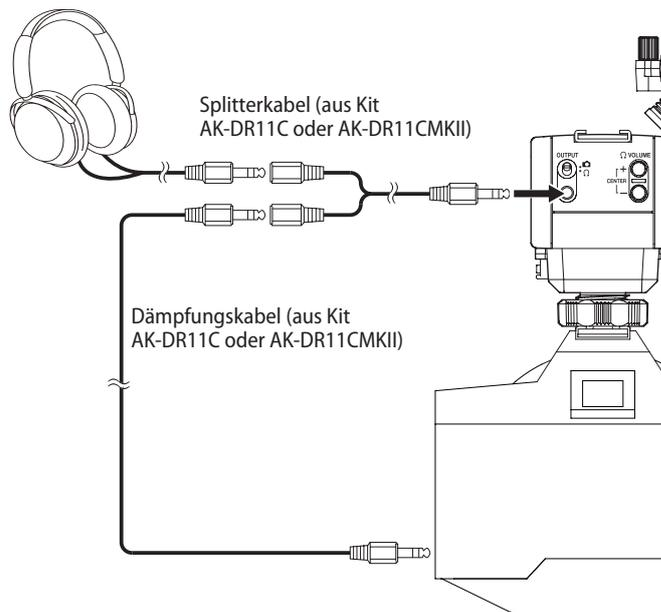
Stellen Sie den Schalter **OUTPUT** (14) auf Kopfhörer (Ω). Verwenden Sie Splitter- und Dämpfungskabel aus den Kits TASCAM AK-DR11C oder AK-DR11CMKII, um den Anschluss **OUTPUT** (15) mit der Kamera und einem Kopf- oder Ohrhörer zu verbinden.
